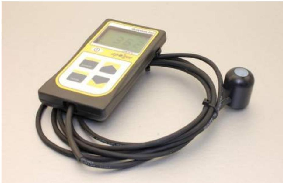
그림 14. 광합성광량자속밀도(PPFD) 센서(SQ-110, Apogee사)
